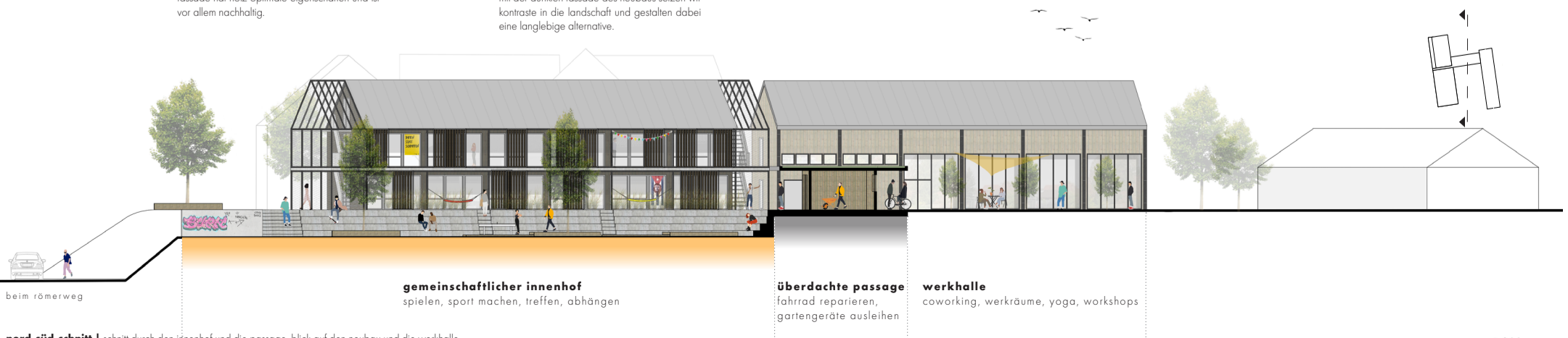
nord-süd-schnitt | schnitt durch den innenhof und die passage, blick auf den neubau und die werkhalle
